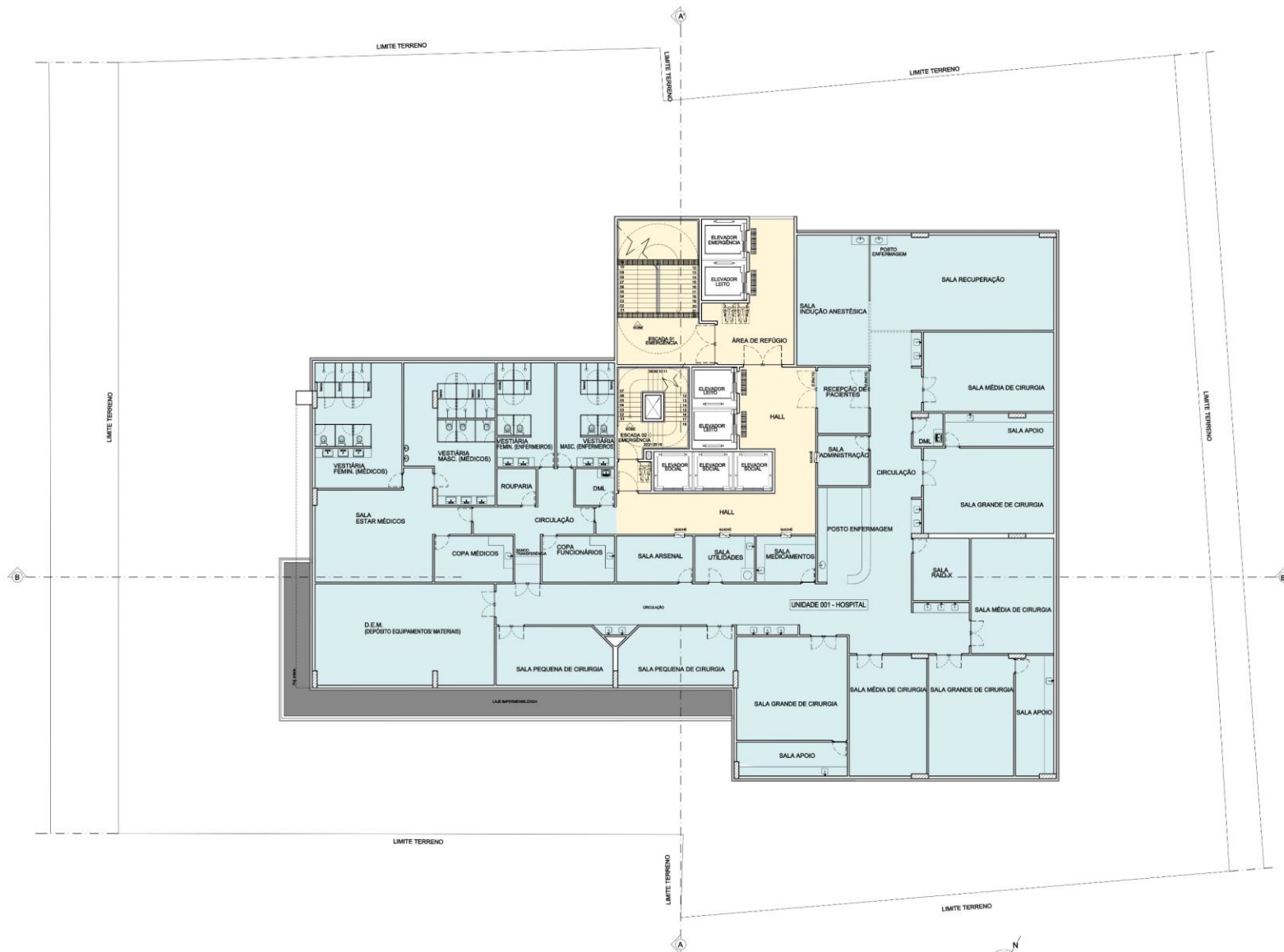
PLANTA BAIXA PAVIMENTO BLOCO CIRÚRGICO ESCALA 1/100
